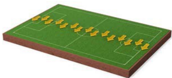
Kunstgress installert i samme retning
